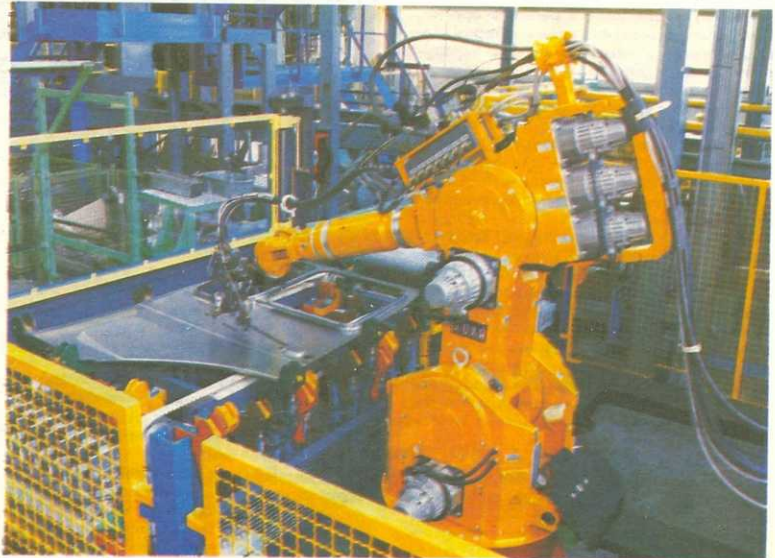
Желтые роботы КУКА на сборке кабин грузовиков. Их действия кажутся волшебством — от манипуляции с деталями трудно оторвать взор.
