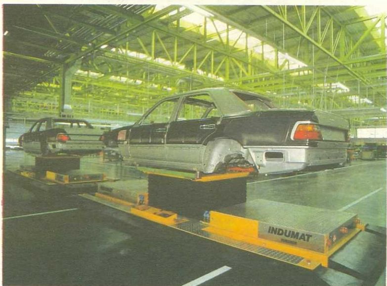
Платформы «Индумат» на магнитной подушке, управляемые компьютером с командного пункта.
