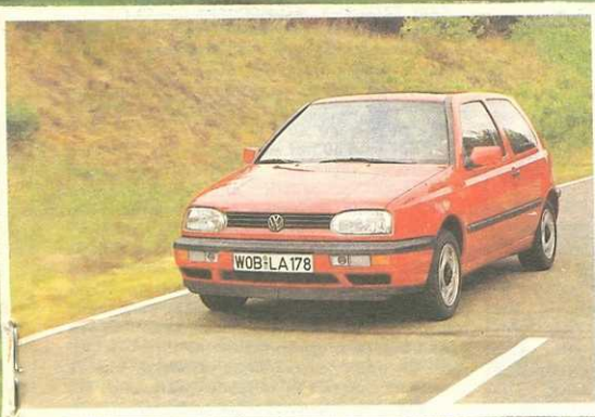
"Фольксваген-Гольф" 3-го поколения, 1992 г. Самый популярный европейский автомобиль. Кузов — 3- и 5-дверный хэтчбек или 5-дверный универсал. Двигатели: 1391—2792 см 3 , 60—174 л. с. Скорость — 156—225 км/ч.
