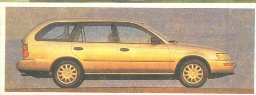
"Тойота-Королла-DX", 1993 г. Модель поколения с кузовом "универсал" для рикаанского рынка. Двигатель: 1762 см 3 л. с. Скорость — 190 км/ч.
