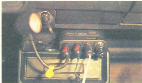
В автомобилях ВАЗа блок-вставки мешают включить третью передачу.
