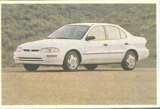
"Гео-Призис-LSi", 1993 г. Автомобиль "Дженерал моторс" американо-японского производства на базе "Тойоты-Короллы". Кузов — 4-дверный седан. Двигатели: 1587—1762 см 3 , 106—116 л. с. Скорость — 185—195 км/ч.
