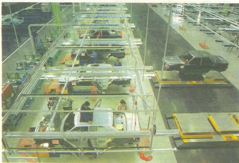
Вместо главного конвейера в Раштате — расположенные один за другим сборочные посты.
