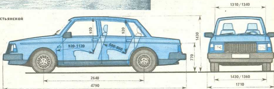
Габаритные размеры «Волво-240» в числителе — размер спереди, в знаменателе — сзади.
